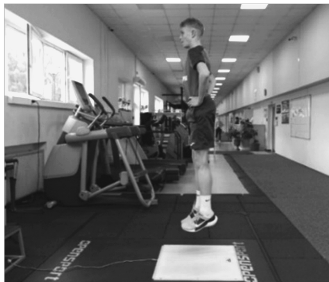
Рис. 1. Тензометрический мат, применяемый в исследовании для выполнения вертикальных прыжков
