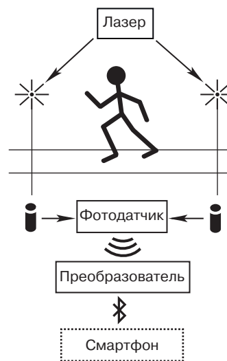
Рис. 1. Блок-схема устройства экспресс-информации о скорости бега и параметрах беговых шагов
